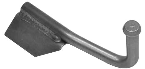
Löttco produziert Aufhänge- und Haltersysteme für PKW-Abgasanlagen, sowohl für die Montage am Auspuffsystem, wie auch für die Aufnahme im Unterbodenbereich. Diese werden gefertigt aus Draht, Rohr oder Blech, gebogen, gestaucht, gestanzt und geschweisst, auf Wunsch montiert mit Halteschlaufe.
